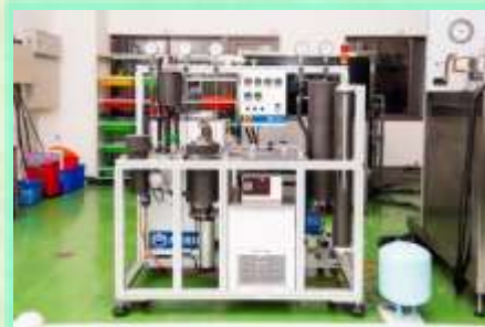
環保冷媒萃取設備
