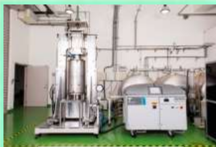
超高壓水設備
