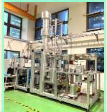
超臨界CO 2 分餾設備
