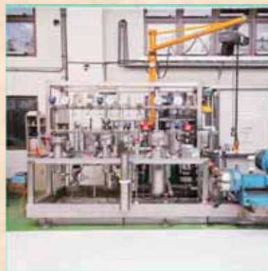
超臨界CO 2 萃取設備
