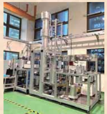
超臨界CO 2 分餾設備
