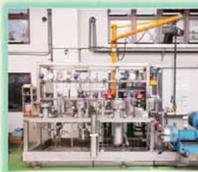
超臨界CO 2 萃取設備
