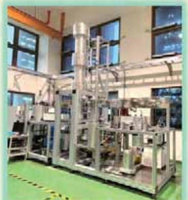
超臨界CO 2 分餾設備
