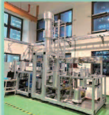
超臨界CO 2 分餾設備
