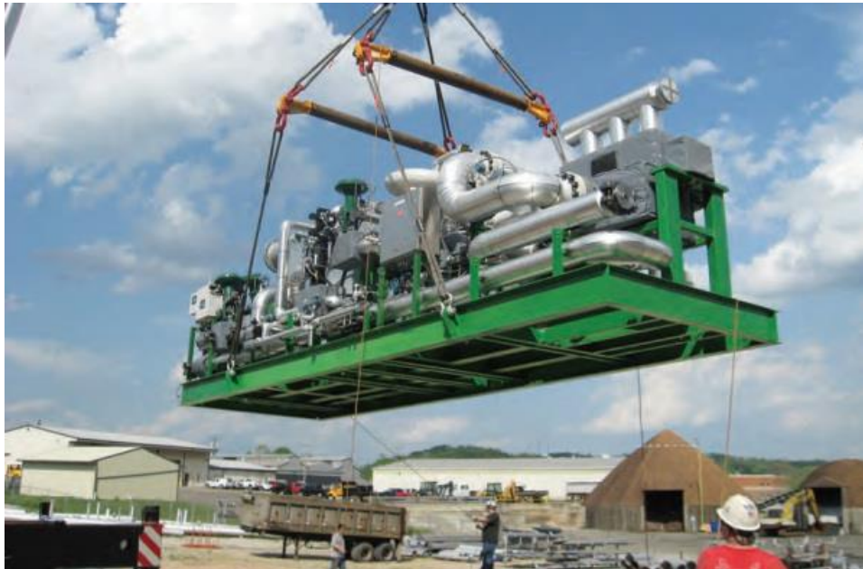
圖 2：準備裝載運輸的 Echogen 廢熱回收發電系統。
