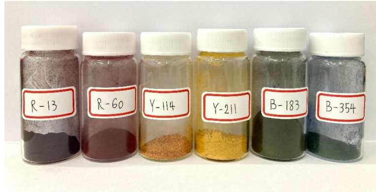
圖 1 純化後的染料能在超臨界狀態下完全溶解，進行染色。
