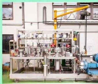
超臨界CO 2 萃取設備
