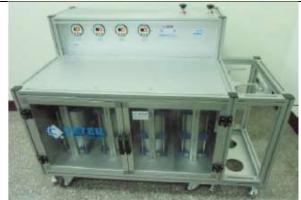
空氣加壓系統 5kg/cm<sup>2</sup>加壓至500kg/cm<sup>2</sup>
