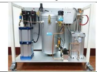
流體加壓單元 水壓加壓至 3000kg/cm²
