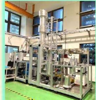
超臨界CO 2 分餾設備
